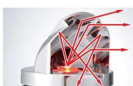
派特萊LED旋轉警示燈使用特殊設計的反射構造(擁有專利)。雖然LED物理特性相比白熾燈具有聚光效果強，散光效果差的特點，但透過特殊設計的反射構造，能克服LED物理特性達到全方位的充分散光的視覺效果。
